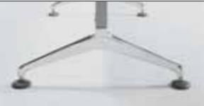
I → Basi in alluminio lucidato disponibili con piedini regolabili in tecnopoliomerico e acciaio zincato oppure con ruote piroettanti con e senza freno. GB → Bases in polished aluminium available with adjustable feet in high-tech polymer and zinc-coated steel or with swivel castors, with or without brake.
