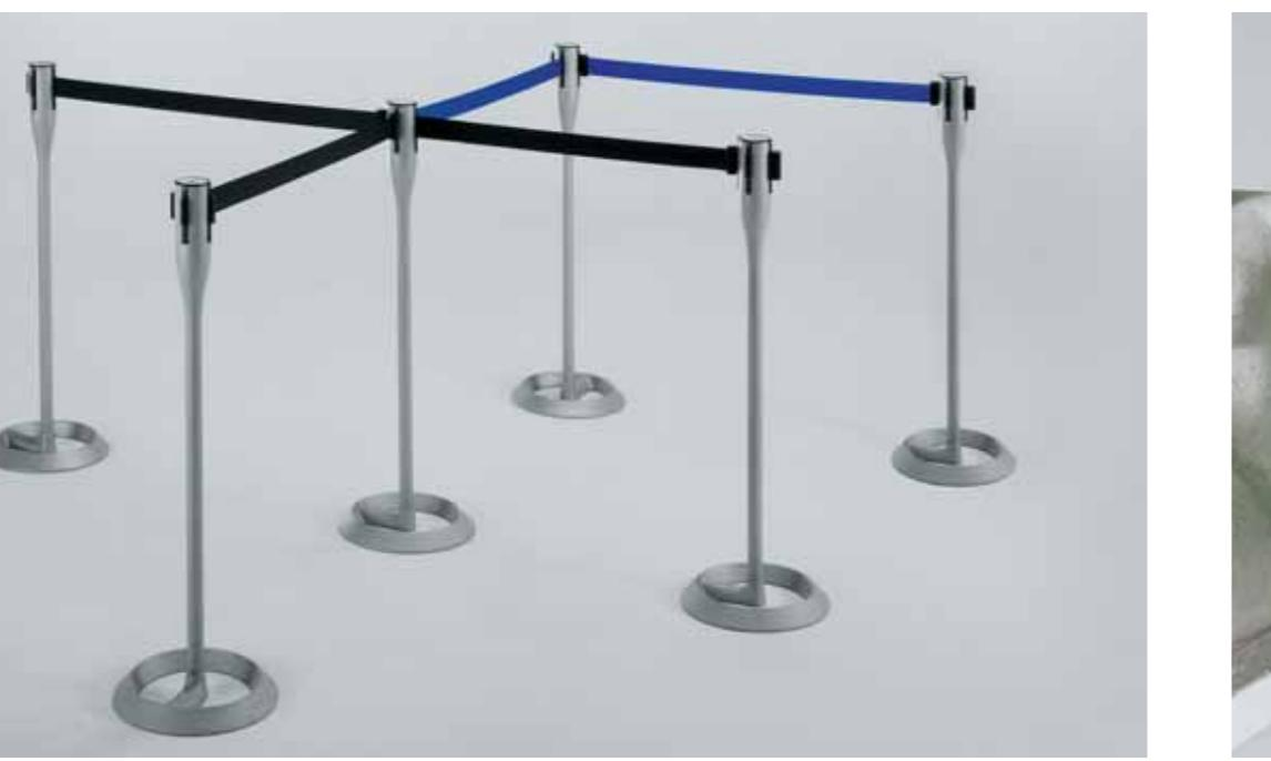
I→La colonnina con nastro estensibile della serie Battista è ottenuta mediante una sofisticata lavorazione del tubolare d'acciaio che viene conificato per poter passare da un ø 70 mm ad un ø 32 mm. Questa tecnologia permette di realizzare una colonnina dalla forma sinuosa, esile nella parte inferiore per ridurre l'impatto visivo.
